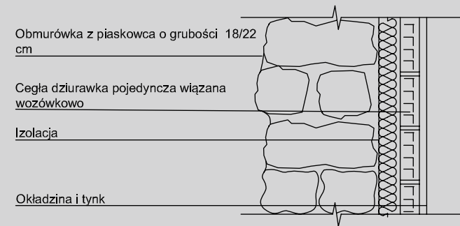
ŚCIANA NOŚNA Z DWUWARSTOWĄ OBMURÓWKĄ
